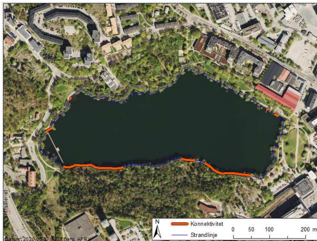
Figur 9. Bedömning av konnektivitet till närområde och svämplan i Trekanten. De röda sträcken visar områdena som bedöms ha bristande konnektivitet.
